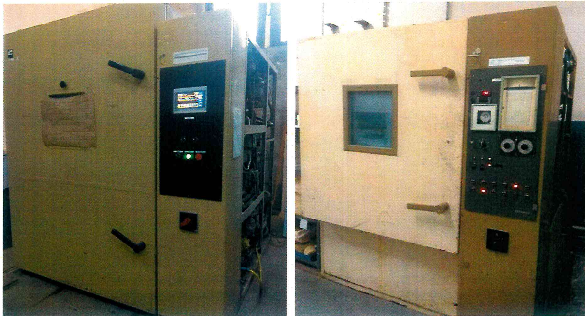
Рисунок 3 – Кліматичні камери для проведення циклічних кліматичних впливів
